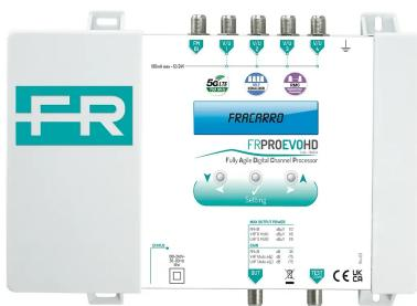
Centrale programmabile per il filtraggio altamente selettivo dei canali televisivi con **5 ingressi** (B1+FM, 4x VHF/UHF flessibili) e livello di uscita 118dB $\mu$ V per ciascun filtro. **32 filtri da 1 a 6 canali**, ciascuno con 9 livelli di selettività. Dalla Rev.03 sono state aggiunte le nuove funzionalità: **Self equalizer** e **RMC**
