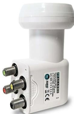
LNB Quattro con 4 uscite con polarità separate H/V,
