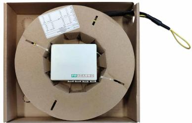
**Scatola di Terminazione Ottica d'Appartamento in plastica, pre-connettorezzato su entrambi i lati, con 4 bussole SC/APC e shooter; ordinabile con misura **custom 41-49m** di cavo da 4 fibre per gli impianti multiservizio **FTTH**; soluzione molto utile per portare all'interno di ogni singola unità abitativa tutti i servizi centralizzati nel CSOE degli impianti FTTH.**
