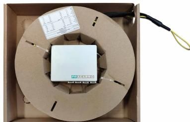
**Scatola di Terminazione Ottica d'Appartamento in plastica**, pre-connettorezzato sul solo **lato STOA**, con 4 bussole SC/APC e shooter; disponibile con **40m** di cavo da 4 fibre per gli impianti multiservizio **FTTH**; soluzione molto utile per portare all'interno di ogni singola unità abitativa tutti i servizi centralizzati nel CSOE degli impianti FTTH.
