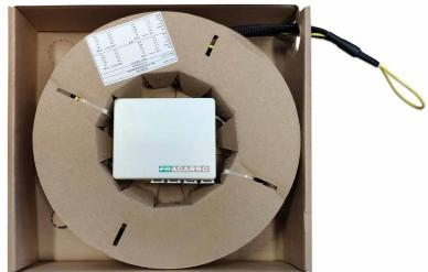
**Scatola di Terminazione Ottica d'Appartamento in plastica,** pre-connettorizzato su **entrambi i lati**, con 4 bussole SC/APC e shooter; disponibile con **30m** di cavo da 4 fibre per gli impianti multiservizio **FTTH**; soluzione molto utile per portare all'interno di ogni singola unità abitativa tutti i servizi centralizzati nel CSOE degli impianti FTTH.
