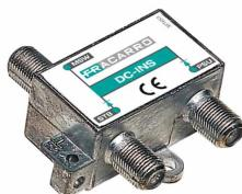
Inseritore di tensione con protezione dei toni DiSEqC generati dal ricevitore o dal decoder e massima corrente di attraversamento 450mA, sufficiente per alimentare una porta SCR (190mA tipici) o una porta SCD2 dCSS (350mA tipici).
