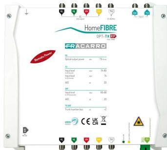
Trasmettitore ottico per la distribuzione fino a 4 satelliti su una singola fibra con tecnologia CWDM (Coarse Wavelength Division Multiplexing). Soluzione innovativa che permette di trasmettere l'intera banda TV, comprensiva dei segnali radio, e una intera posizione orbitale su una singola fibra. 7dBm con laser FP SAT+TV+FM, lunghezza d'onda 1310nm.
