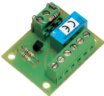
La scheda interfaccia R24HRP dispone di una uscita a relè a doppio scambio da 1A max. Il comando di attivazione può essere dato da una tensione a 12V oppure da un comando logico (uscita Open Collector). Il modulo è particolarmente indicato per aumentare le uscite a relè a scambi puliti sulle centrali di comando
