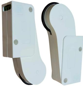
Contatto a rotella per tapparelle, grazie alla sua particolare costruzione è in grado di seguire il movimento della tapparella, per merito dell'asta basculante integrata. Il contatto è completo di morsettiera a 4 poli NC, per uscita allarme e uscita tamper. Il contatto è disponibile in due modelli: bianco oppure marrone.
