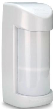
Sensore volumetrico da esterno a tripla tecnologia, 2 IR+MW con funzione antimascheramento a IR attivi, che offre un elevatissimo grado di protezione, sia per applicazioni residenziali che commerciali, testimoniato dalla conformità alla normativa EN 50131-I Grado 3.
