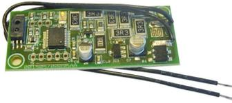
Kit riscaldatore per rivelatori serie SHIELD sia cablati che wireless. Nel caso di collegamento con rivelatori SHIELD wireless, (SHIELD C/WL 910380 e SHIELD V/WL 910381) è necessario collegare una fonte di alimentazione esterna a 12 Vdc.
