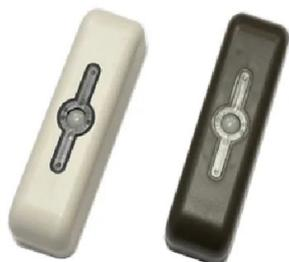
Rivelatore a doppia tecnologia filare a tenda con microonda a 24GHz, Bianco, per la protezione di porte e finestre. Portata regolabile da 2 a 5 metri. Protezione antiapertura e led walk Test ed antimascheramento. Installazione in 2 modalità: dall'alto verso il basso oppure su un lato.
