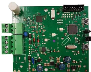
MOD-WL16 consente di realizzare sistemi misti collegando fino a 16 rilevatori, 16 telecomandi e 4 sirene del sistema WIRELESS Fracarro ad una centrale Defender filare tramite connessione BUS. L'interfaccia può essere alloggiata all'interno del contenitore plastico MOD-BOX. La programmazione del dispositivo è facile ed intuitiva grazie al menù della centrale Defender utilizzando la tastiera T8N oppure il software Programmer Sicurezza.
