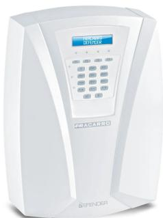
Centrale wireless multicanale bi-direzionale con tastiera integrata e display a cristalli liquidi. Defender Hybrid può gestire di serie fino a 40 dispositivi wireless e 8 ingressi filari a bordo. Con accessori interamente su BUS gli ingressi sono espandibili a 64 (filari o WL) e liberamente programmabili.
