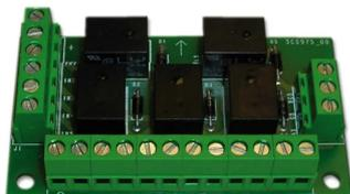
Scheda interfaccia che dispone di 5 uscite relè a doppio scambio da 1A a 12V max. Il comando di attivazione può essere dato da un comando logico (uscita Open Collector). Il modulo è particolarmente indicato per aumentare le uscite a relè a scambi puliti sulle centrali di comando.
