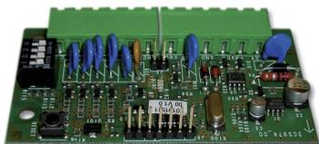
Schede di espansione a 4 ingressi (M4IBUS) oppure a 8 ingressi (M8IBUS) che permette di aumentare il numero di zone delle centrali filari del sistema Defender. Grazie alla connessione a BUS RS485 è possibile remotizzare questi moduli all'interno dell'impianto o per creare dei punti concentratori senza avere la necessità di portare tutte le zone in centrale
