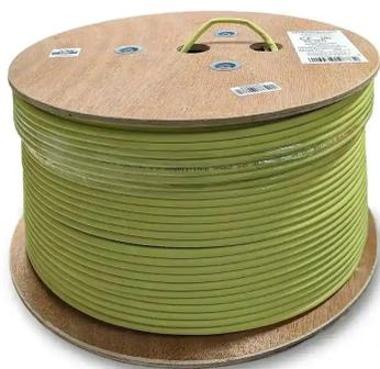
Cavo di rete da **interno CAT 6A U/UTP Cca** con guaina LSZH, matassa da **305 metri** composto da 4 coppie bilanciate con conduttori in rame rosso flessibile **AWG 23**.
