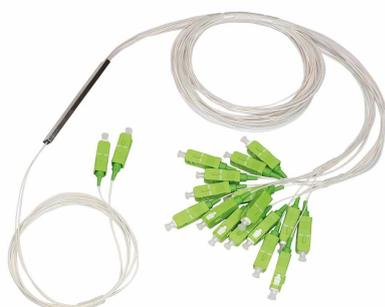
**Partitore ottico PLC miniaturizzato con 2 ingressi e 16 uscite** adatto alla realizzazione della ridondanza nei sistemi GPON; dotato di tecnologia planar waveguide che consente **bassissime perdite d'inserzione.**
