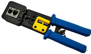
Pinza per crimpare plug RJ-45 a 8 posizioni su cavi di categoria 5E, 6 e 6A con corpo in metallo brunito e manici ergonomici in plastica; anche per RJ-11.
