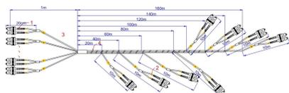
**Cavo** in fibra ottica monomodale da **interno**, con **16 fibre** e lunghezza **170 m**; dotato di **8 stacchi da 10m connessi** ogni 20m con **SC/APC Duplex** e sistema di trazione **PULL**. Molto utile per stendere la fibra su una montante e **portare i servizi su 2 fibre per ciascuno di 8 piani**, in particolare modo negli impianti **GPON** delle strutture ricettive. Rispetta i requisiti della classe **Cca** secondo la normativa **CPR EN 50575**.
