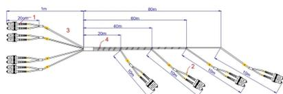
**Cavo** in fibra ottica monomodale da **interno**, con **8 fibre** e lunghezza **90 m**; dotato di **4 stacchi da 10m connessi ogni 20m con SC/APC Duplex** e sistema di trazione **PULL**. Molto utile per stendere la fibra su una montante e **portare i servizi su 2 fibre per ciascuno di 4 piani**, in particolare modo negli impianti **GPON** delle strutture ricettive.
