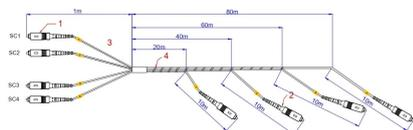
**Cavo** in fibra ottica monomodale da **interno**, con **4 fibre** e lunghezza **90 m**; dotato di **4 stacchi da 10m connessi ogni 20m con SC/APC Simplex** e sistema di trazione **PULL**. Molto utile per stendere la fibra su una montante e **portare i servizi con 1 fibra su ciascuno di 4 piani**, in particolar modo negli impianti **GPON** delle strutture ricettive.
