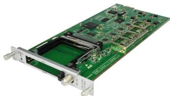
**GX-4C2CI-BP-00** è dotato di un connettore di ingresso coassiale RF (F femmina) e due slot Common Interface PCMCIA. Il modulo è in grado di sintonizzare fino a **quattro multiplex QAM digitali DVB-C**, decodificare i programmi criptati tramite le opportune CAM e Smart Card inseribili negli slot C.I. e condividere i contenuti tramite il back panel dello chassis **GALAXIA**.
