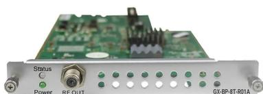
Il **multi-modulatore digitale GX-BP-8T-R01A** è dotato di un connettore di uscita coassiale RF (F Femmina) ed è in grado di creare fino a **8 multiplex digitali terrestri DVB-T**. Il modulatore è la soluzione di transmodulazione ideale ed efficiente per la distribuzione dei programmi sintonizzati dai moduli satellitari o digitali terrestri inseriti nello stesso chassis o disponibili in condivisione sullo stesso backplane **GALAXIA**, anche quelli IPTV in ingresso multicast.
