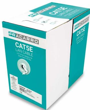
Cavo di rete da interno CAT 5E con guaina in PVC, matassa svolgi cavo da 305 metri composto da 4 coppie bilanciate da 100 Ohm con conduttori in rame rosso flessibile AWG 24. Le caratteristiche soddisfano i requisiti di **Cat. 5E Classe D** fino a 100 Mhz secondo gli standard ANSI/TIA 568.2-D e ISO/IEC 11801. Idoneo per applicazioni Gigabit Ethernet (IEEE 802.3ab).
