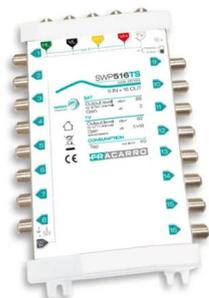
Multiswitch **compatto** a **5 ingressi** e **16 uscite derivate** con dip switch per selezionare il guadagno **TV attivo o passivo**.
