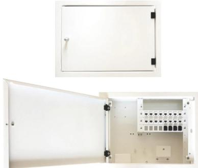
Box di appartamento da murare metallico miniaturizzato per l'alloggiamento degli apparati attivi. Completo di pannelli per inserti KEYSTONE e tasche metalliche per l'alloggiamento delle STOA (dimensioni 390x305x110mm esclusa cornice)
