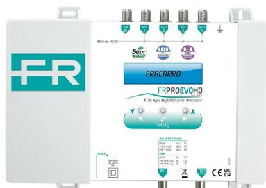
**Centrale programmabile** per il filtraggio altamente selettivo dei canali televisivi con **5 ingressi** (B1+FM, 4x VHF/UHF flessibili) e livello di uscita 118dB $\mu$ V per ciascun filtro. **32 filtri da 1 a 6 canali**, ciascuno con 9 livelli di selettività. Dalla Rev.03 sono state aggiunte le nuove funzionalità: **Self equalizer** e **RMC**
