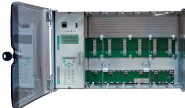
Il cestello 3DG-BOX è dotato di **6 slot disponibili** per installare, alimentare e programmare i trasmodulatori della famiglia 3DGFlex. Il box è dotato di tutti gli accessori per il fissaggio a muro, a pavimento o su rack standard 19".
