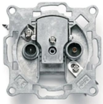
**Presa rotonda da incasso derivata** con attenuazione 6dB; **2 uscite demiscelate** con connettore IEC femmina per la banda TV (5-40MHz, 47-862MHz) e connettore IEC maschio per la banda Satellite (950-2300MHz).
