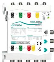
Multiswitch **SCD2 (dCSS) in cascata**, **5 ingressi** con CAG compatibili anche con LNB **Wideband** e **2 uscite** derivate con 16 frequenze ciascuna e **autodetection della modalità di funzionamento**, alimentato interamente da **connettore DC-IN**, da **linea VL** o da decoder. Frequenze SKY Italia e SKY UK.
