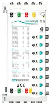
Multiswitch SCD2 (dCSS) in cascata, 5 ingressi attivi e regolabili con CAG compatibili anche con LNB Wideband e 8 uscite derivate con 16 frequenze ciascuna e autodetection della modalità di funzionamento, alimentato interamente da connettore DC-IN, da linea VL o da decoder. Frequenze SKY Italia.
