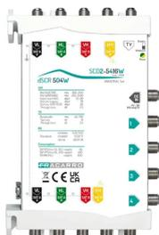
Multiswitch **SCD2 (dCSS) in cascata**, **5 ingressi** con CAG compatibili anche con LNB Wideband e **4 uscite** derivate con 16 frequenze ciascuna e **autodetection della modalità di funzionamento**, alimentato interamente da **connettore DC-IN**, da **linea VL** o da decoder. Frequenze SKY Italia e SKY UK.
