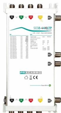
Multiswitch **SCD2 (dCSS) in cascata**, **4 ingressi** con CAG e **4 uscite** derivate con 16 frequenze ciascuna e **autodetection della modalità di funzionamento**, alimentato interamente da decoder o da **linea VL**. Frequenze SKY Italia.
