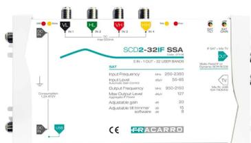
**Centrale IF-IF compatta** per convertire fino a 32 transponder DVB-S/S2 con tecnologia SCD2 (dCSS); **4 ingressi satellite, 1 ingresso TV passivo e 1 derivata miscelata** con livello di uscita totale Satellite **127dBuV**; regolazione del **guadagno Satellite 20dB** e regolazione della **pendenza Satellite 15dB**.
