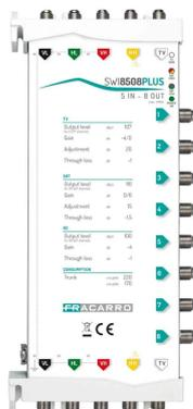
Multiswitch in **cascata** a **5 ingressi** e **8 uscite derivate** con **guadagno attivo** e regolazione separata nelle bande TV e Satellite (banda alta e bassa con regolazioni separate).
