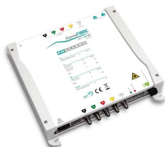
Trasmittitore ottico per la distribuzione fino a 4 satelliti su una singola fibra con tecnologia CWDM (Coarse Wavelength Division Multiplexing). **Soluzione innovativa che permette di trasmettere l'intera banda TV, comprensiva dei segnali radio, e una intera posizione orbitale** su una singola fibra. 7dBm con laser FP SAT+TV+FM, lunghezza d'onda 1310nm. (dimensioni 230x230x50mm)
