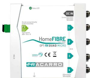
Il ricevitore **OPT OPT-RX QD MICRO** converte il segnale ottico di ingresso in segnale coassiale disponibile su 4 prese TV-SAT miscelate. Il ricevitore può essere alimentato direttamente dai set-top-box collegati alle uscite o dal connettore DC dedicato. Il prodotto è dotato di un LED verde multifunzione che fornisce all'installatore diverse informazioni:
