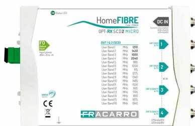
Il ricevitore **OPT-RX SCD MICRO** converte il segnale ottico di ingresso in segnale coassiale disponibile su due uscite dCSS (SCD2) e due uscite Legacy, tutte con il segnale TV miscelato. Il ricevitore può essere alimentato direttamente dai set-top-box oppure tramite un connettore DC dedicato. Il prodotto è dotato di un LED verde multifunzione che fornisce all'installatore diverse informazioni:
