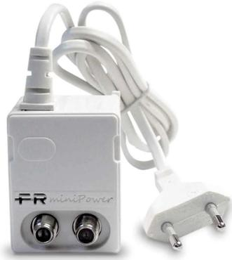
Alimentatore miniaturizzato di tipo switching stabilizzato 24V ad alta efficienza e basso consumo con 1 ingresso, 1 uscita e corrente erogata 130mA. Spina di tipo C di connessione alla rete elettrica.
