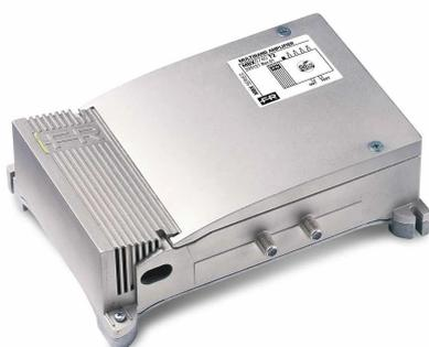
Centrale con 4 ingressi (FM, III+DAB, UHF, UHF) autoalimentata da interno con guadagno 31dB e livello di uscita fino a 125dB $\mu$ V in banda UHF, amplificazioni a bande separate, regolazioni del guadagno (0-20dB) indipendenti per ogni ingresso e bassa figura di rumore. **Tecnologia T2** con filtro integrato per eliminare le interferenze 5G a 694MHz.
