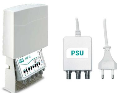
Amplificatore con 3 ingressi (III+DAB, UHF, UHF) da palo con guadagno 28dB e livello di uscita fino a 116dB $\mu$ V in banda UHF, amplificazioni separate VHF/UHF, regolazioni del guadagno (0-15dB) indipendenti per ogni ingresso e bassa figura di rumore. 2 uscite e filtro 5G e 4G LTE 694MHz integrato.
