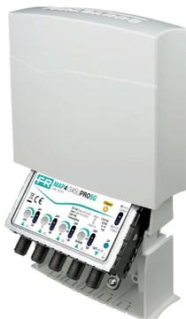
Amplificatore con 4 ingressi (III+DAB, IV, V, UHF) da palo con guadagno 40dB e livello di uscita fino a 110dB $\mu$ V o 120dB $\mu$ V in banda UHF selezionabile, amplificazioni separate VHF/UHF, regolazioni del guadagno (0-15dB) indipendenti per ogni ingresso e bassa figura di rumore. Filtro 5G 694MHz integrato.
