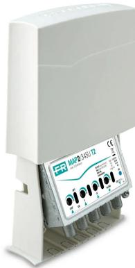
Amplificatore con 2 ingressi (III+DAB, UHF) da palo con guadagno 42dB e livello di uscita fino a **116dB $\mu$ V in banda UHF**, amplificazioni separate VHF/UHF, regolazioni del guadagno (0-15dB) indipendenti per ogni ingresso e bassa figura di rumore. **Tecnologia T2** con filtro integrato per eliminare le interferenze 5G a 694MHz.
