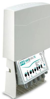
Amplificatore con 1 ingresso (III+DAB+UHF) da palo con guadagno 25dB e livello di uscita fino a **116dB $\mu$ V** in banda UHF, amplificazioni separate VHF/UHF, regolazioni del guadagno (0-15dB) indipendenti per ogni banda e bassa figura di rumore. **Tecnologia T2** con filtro integrato per eliminare le interferenze 5G a 694MHz.
