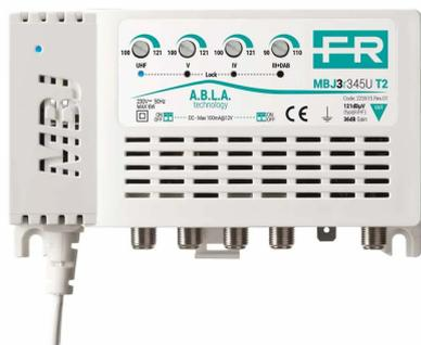
Centralino con 4 ingressi (III+DAB, IV, V, UHF) da interno autoalimentato con guadagno 35dB e livello di uscita fino a 120dB $\mu$ V in banda UHF, amplificazioni separate, regolazioni del livello (20dB) indipendenti per ogni ingresso e bassa figura di rumore. Taratura speciale nelle frequenze di taglio tra banda IV e banda V e tecnologia T2 con filtro integrato per eliminare le interferenze 5G a 694MHz.
