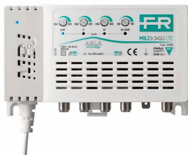
Centralino con 3 ingressi (FM+III+DAB, UHF, UHF) da interno autoalimentato con guadagno 32dB e livello di uscita fino a 120dB $\mu$ V in banda UHF, amplificazioni separate, regolazioni del livello (20dB) indipendenti per ogni ingresso e bassa figura di rumore. Filtro 694MHz 5G e 4G LTE integrato.
