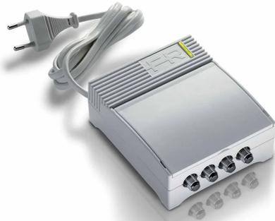
Amplificatore con 1 ingresso (VHF+UHF+SAT) da interno autoalimentato con guadagno 30dB e livello di uscita fino a 100dB $\mu$ V, regolazioni del livello (20dB) TV e SAT separate e bassa figura di rumore.
