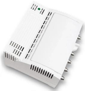
Centralino di linea con 1 ingresso a larga banda (III+DAB+UHF) da interno autoalimentato con guadagno 31dB e livello di uscita fino a **124dB $\mu$ V**, regolazione del guadagno (0-20dB) e bassa figura di rumore.
