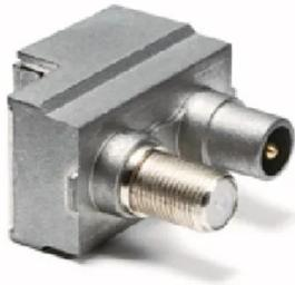
**Presa frutto derivata** con attenuazione 14dB; **2 uscite demiscelate** con connettore IEC maschio per la banda TV (47-862MHz) e connettore F femmina per la banda Satellite (950-2400MHz)
